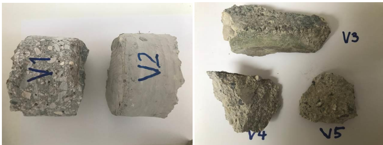
Sliki 19 in 20: Vzorci betona, na katerih so bile izvedene meritve globine prodora karbonatizacije
