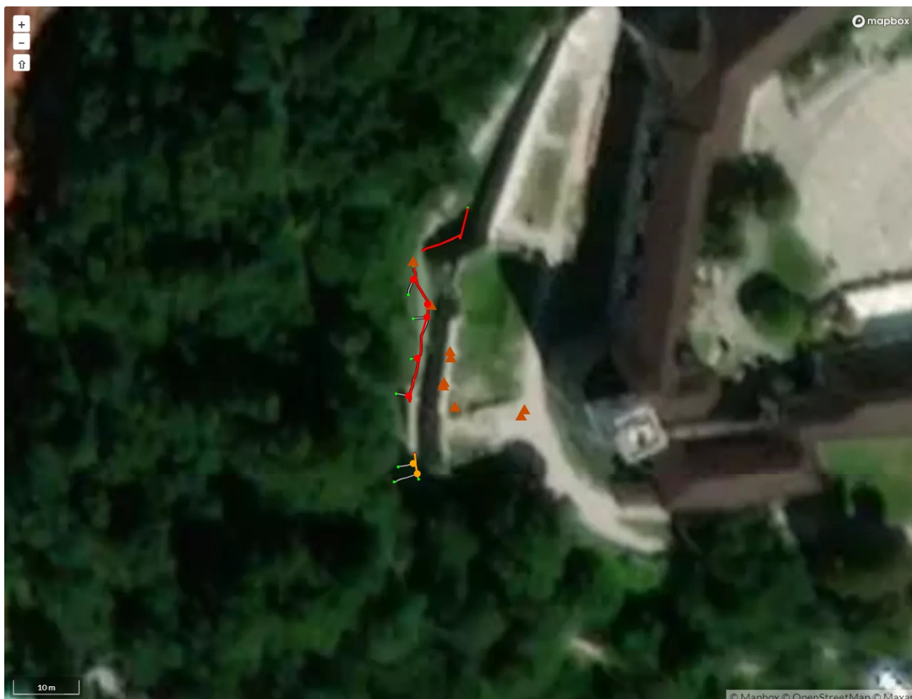
Slika 4: Prikaz posnete kontaktne linije med temelji zidov in kamninsko osnovo. Z rdečo so zidovi obrambnega obzidja, z oranžno pa je označen zid Stolpa piskačev.
